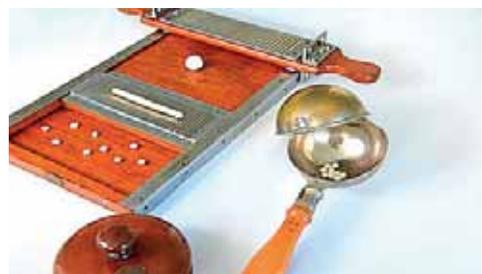
Figura 1 - Pilulador - tabuleiro, régua, rolador e polvilhador
